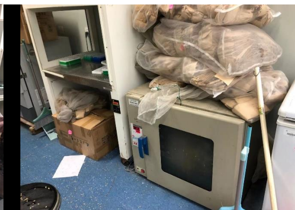
理科楼 A101-103—烘箱周围堆积易燃杂物，房间内未发现灭火设备， 负责人段二超、董慧（左图为初查，右图为复查）
