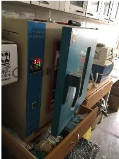
兽医院 301—烘箱放置于木质桌面使用，使用时门未关且无人在场，实验室内饮食。 负责人周振雷(复查新增)
