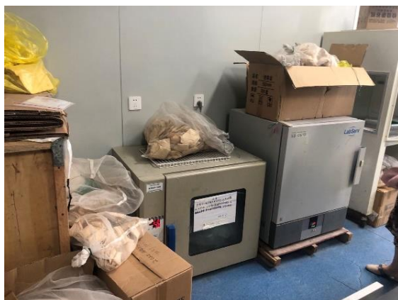
理科楼 A101-103—烘箱周围堆积易燃杂物，房间内未发现灭火设备， 负责人段二超、董慧（左图为初查，右图为复查）
