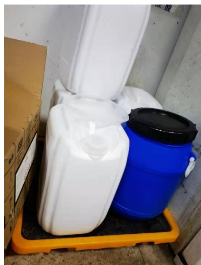
理科楼 B207—废液桶和废胶桶上未张贴危废标签，废液桶叠放，负责人叶永浩（左图为初查，右图为复查）
